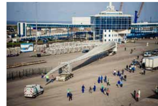
7MWの風力発電ブレードを搬送する様子
