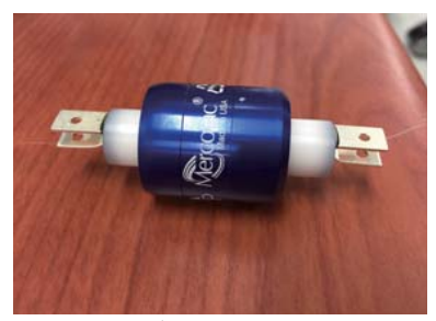
通電部摩擦がない NASA 採用の回転コネクタ
